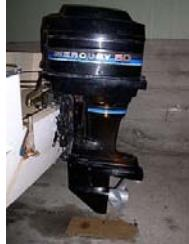
FUERA DE BORDA: motor de explosión que se instala en la parte exterior de una embarcación y que, provisto de una hélice, permite la impulsión y dirección de esta misma.
