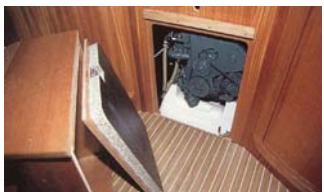
INTERIOR o INTERNO: motor instalado en el interior de la embarcación, rígidamente unido al casco.
